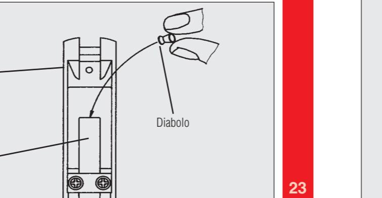
Verwenden Sie **nur** Diabolo-Kugeln und **keine** Stahlbolzen-/pfeile, Rundkugeln oder ähnliches. Achten Sie darauf, dass die Kugeln nicht beschädigt sind. Verwenden Sie keine gebrauchten Kugeln. Beachten Sie das jeweilige Kaliber Ihrer Waffe.
