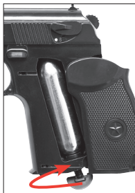
Serrer à fond la vis de pression.
